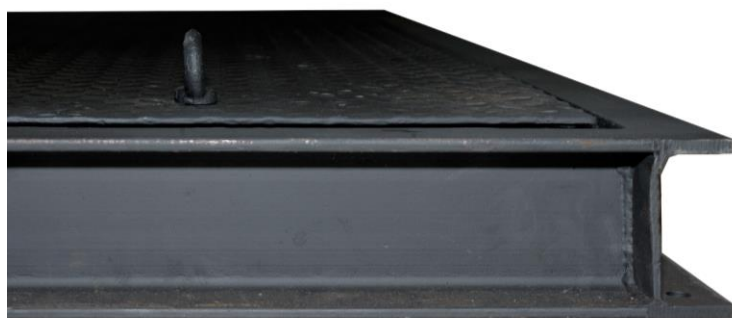
Рис. 5 – Проверка равномерности распределения платформы весов по высоте монтажной рамы после установки
