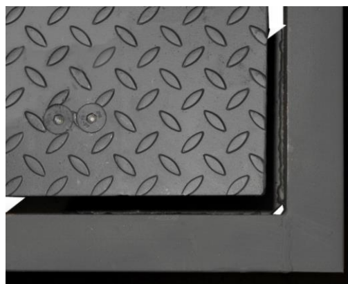
Рис. 4 – Весоизмерительная платформа установлена в монтажную раму. Внешний вид
