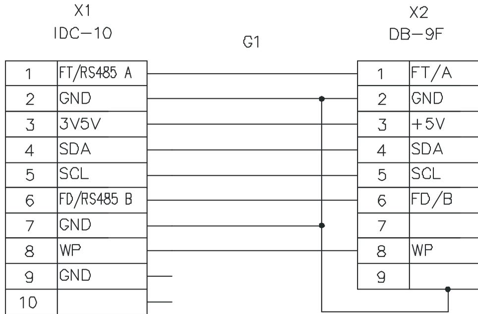
Схема жгута ЭК1097.01.03.000 от разъема платы индикации к пультовому разъему подключения интерфейса RS232.
