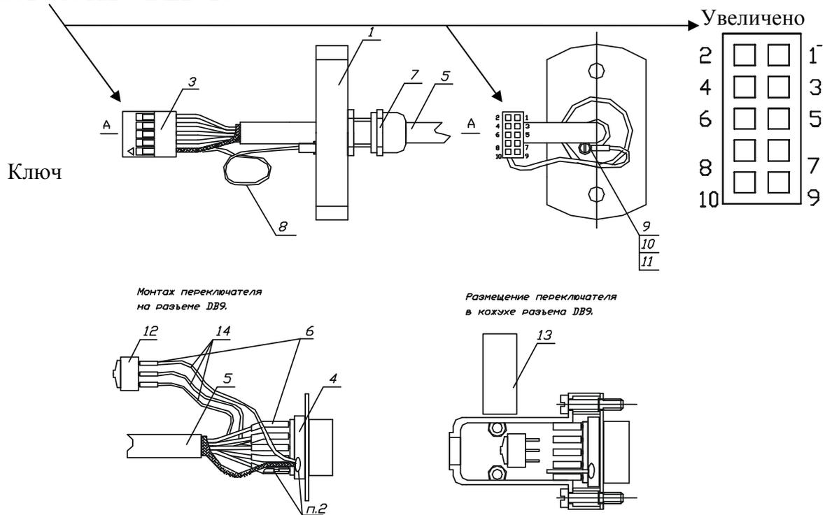
1 – Крышка датчика, 3 - Розетка BLD-10, 4 - Вилка DB-9M, 12 - Переключатель SS6
