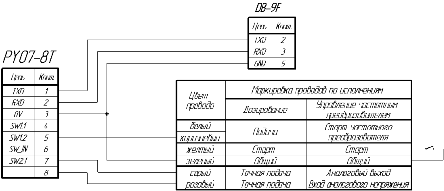
Расположение контактов разъема PY07-8T
