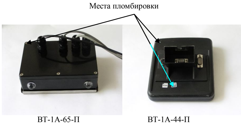
Рисунок 2- Места пломбировки от несанкционированного доступа
