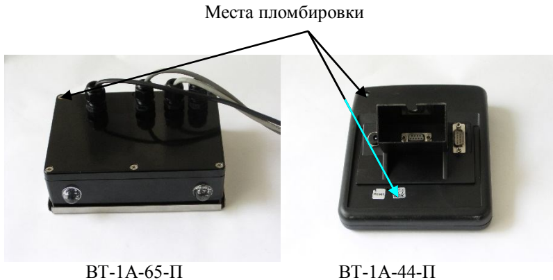
Рисунок 2- Места пломбировки от несанкционированного доступа
