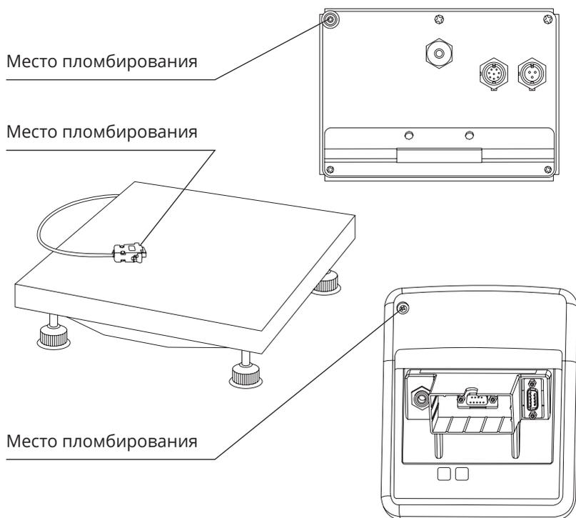
Рисунок 4 – Место пломбировки от несанкционированного доступа.
