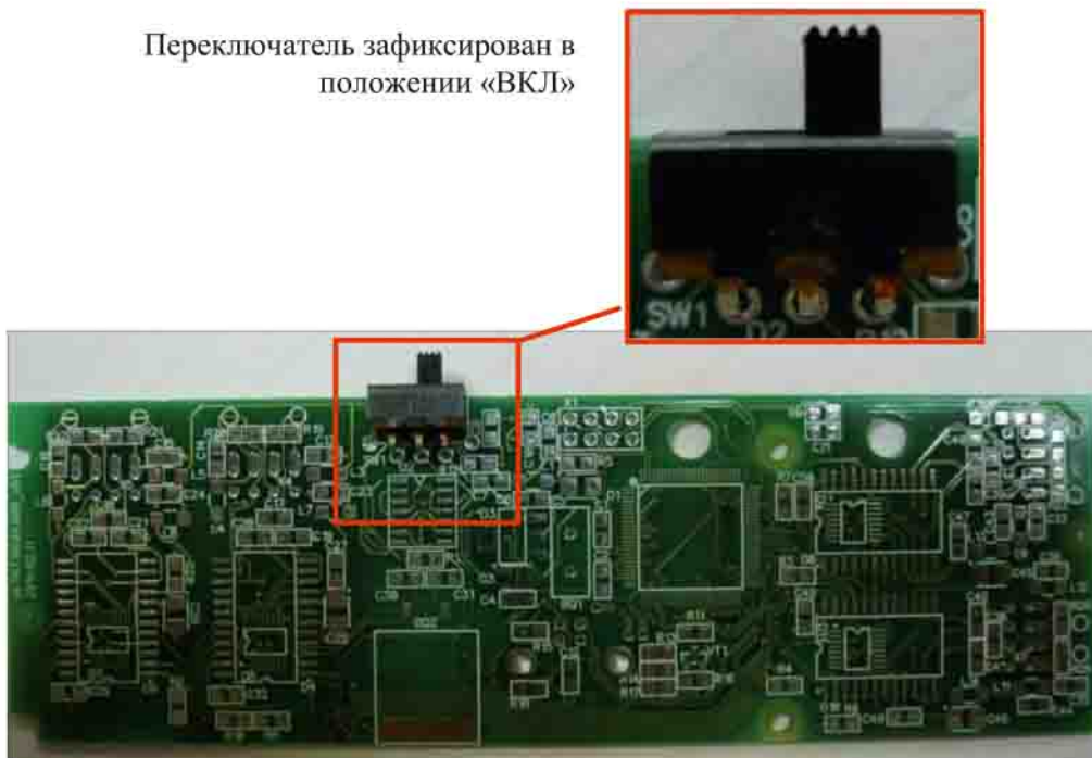
Рисунок 8.4 – Фиксация переключателя на плате измерителя
