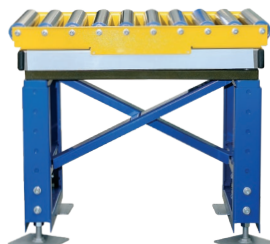
Входной и выходной рольганг
